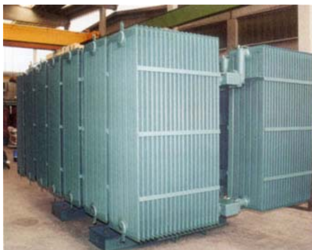
Tanque con radiadores desmontables
